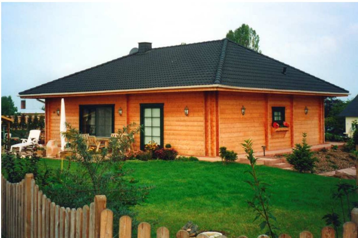
Ausführung in zweischaliger Blockbohlenkonstruktion
